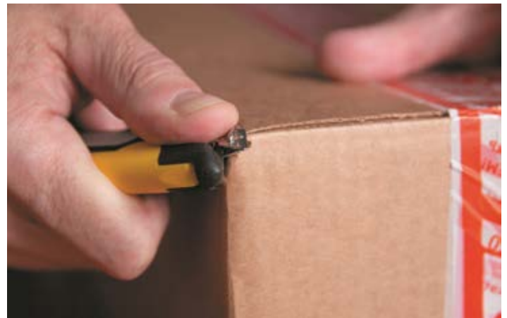
Ровное вскрытие с помощью направляющей
